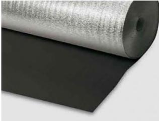
*Caucho reciclado (Acetato de vinilo reticulado y expandido por compresión), fabricado y diseñado especialmente para la conservación y el cuidado del parquet y suelos laminados. Material anti bacteriano e impermeable de celda cerrada no poroso. Excelente aislante acústico, no almacena cargas electromagnéticas. La lámina de HDPE, le confiere una protección adicional frente a la humedad, para el cumplimiento general de salubridades prescritas en el documento básico HS de salubridad del CTE.*
