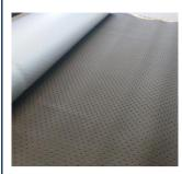
Es caucho reciclado (Acetato de vinilo reticulado y expandido porcompresión), fabricado y diseñado especialmente para la conservación y el cuidado del parquet y suelos laminados. Material anti bacteriano e impermeable de celda cerrada no poroso. Excelente aislante acústico, no almacena cargas electromagnéticas.
